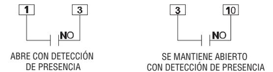
LOS CABLES DE LOS DETECTORES Y DE ALIMENTACIÓN DE DETECTORES SE CONECTAN DIRECTAMENTE AL DETECTOR. CONSULTAR LAS INSTRUCCIONES SUMINISTRADAS CON EL DETECTOR.
